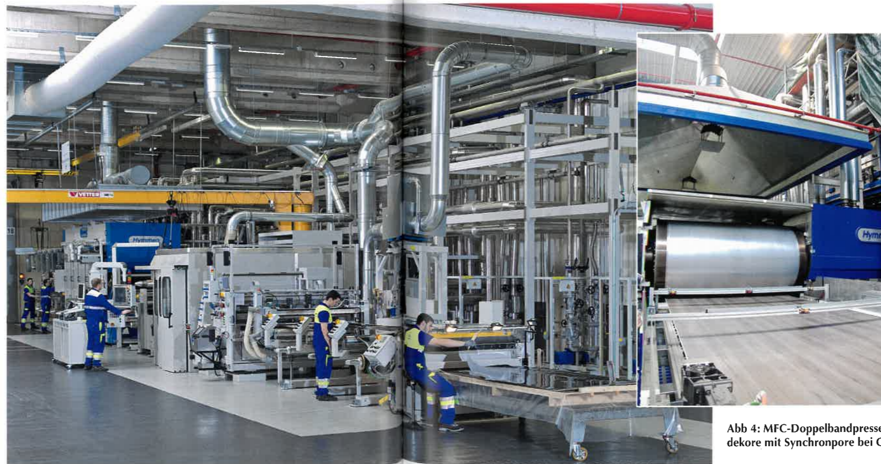
Abb. 3: HPL-Doppelbandpresse für Hochglanzlamine bei Egger (Foto Quelle: Egger)
