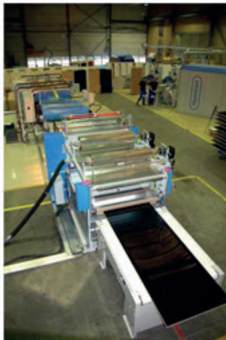
Fig. 3a, 3b, 3c: el calendario, la pieza central de una línea CCI en el Centro de Tecnología Hymmen Fig. 3a, 3b, 3c: The calender, the centerpiece of a CCI line at the Hymmen Technology Center Fig. 3a, 3b, 3c: o calendário, a peça central de uma linha CCI no Hymmen Technology Center
