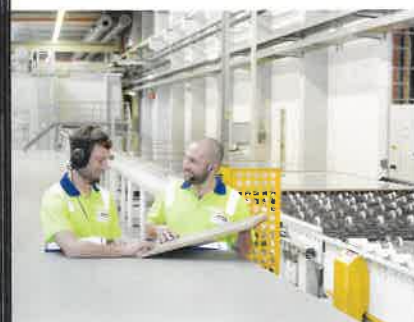
>Die veredelten MDF-Platten auf dem Weg zur Abstapelung. Dank der Calander Coating Inert (CCI)-Technologie muss Egger keinerlei Ruhezeiten beachten.
