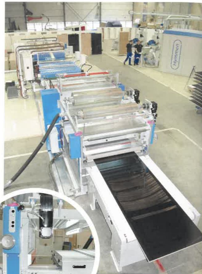
>Oben & links: Ein Blick auf den Kalender, das Kernstück der CCI-Anlage, hier im Hymmen Technikum.
