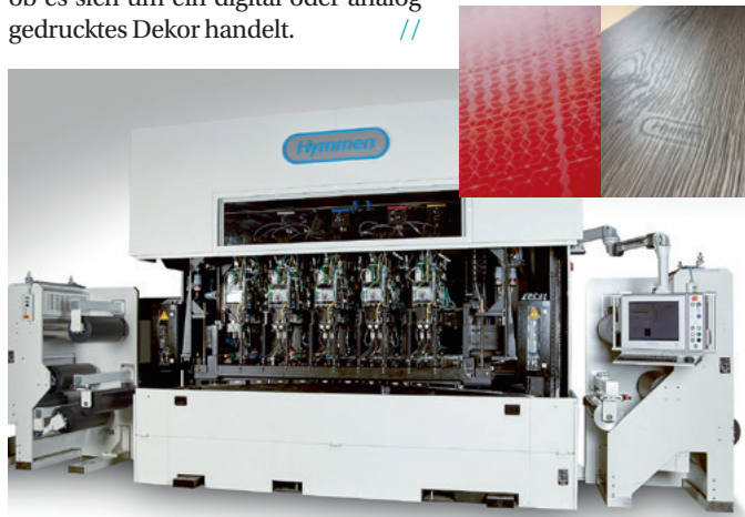
Die Hymmen-Jupiter Digital Printing Lines für Digitaldruck auf Kantenbändern – mit Digital Lacquer Embossing lassen sich verschiedene strukturierte Oberflächen erzeugen (kl. Bilder)
