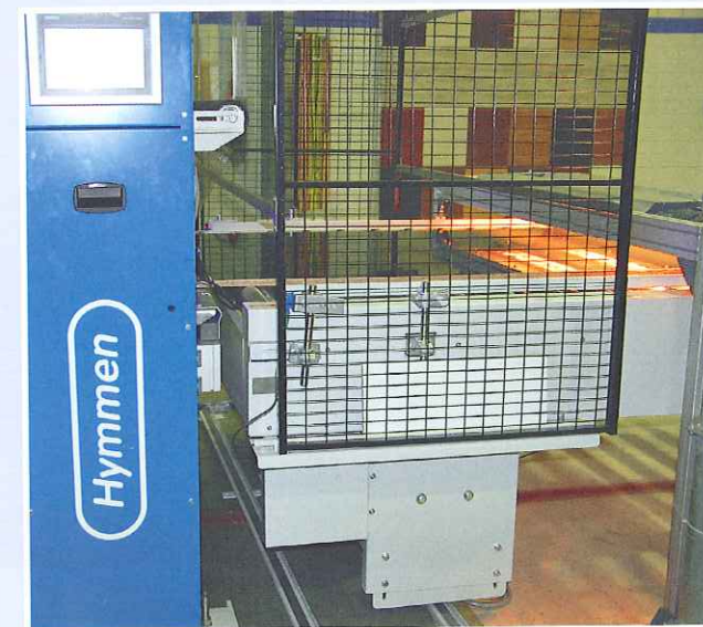
... wo der UV-Lack unter inertem Bedingungen durch eine Folie hindurch getrocknet wird
