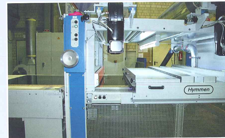
... wo der UV-Lack unter inertem Bedingungen durch eine Folie hindurch getrocknet wird
