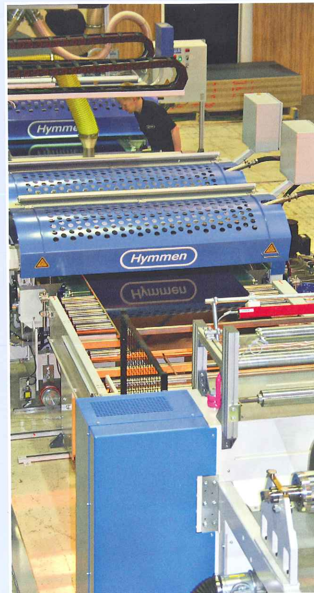
Die lackierten Oberflächen kommen im noch nassen Zustand in den Kalender ...
