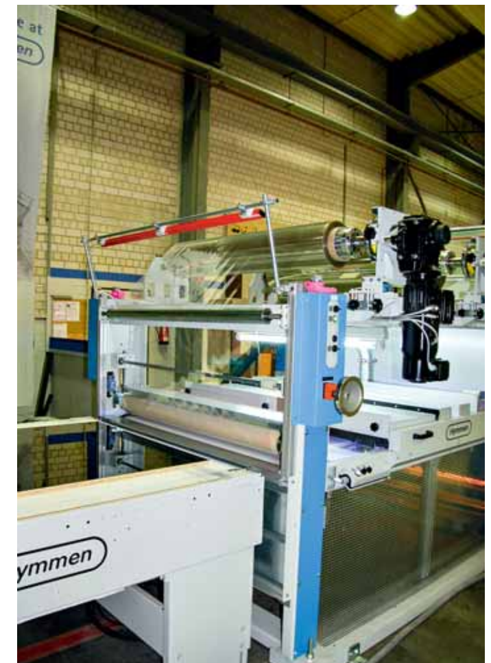
Abb. 6.1/2: Die Calender Coating Inert (CCI) Anlage
