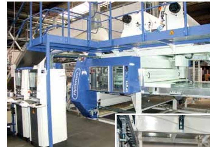
Abb. 3.1/2/3: Exakte Lückensteuerung und hochdynamisches Schnittsystem zur Plattentrennung
