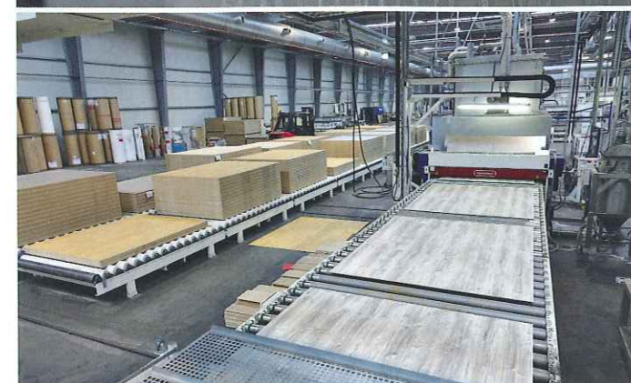
Hymmen 45 m-Produktionslinie mit Digitaldruck/Flüssigbeschichtung/Doppelbandpresse
