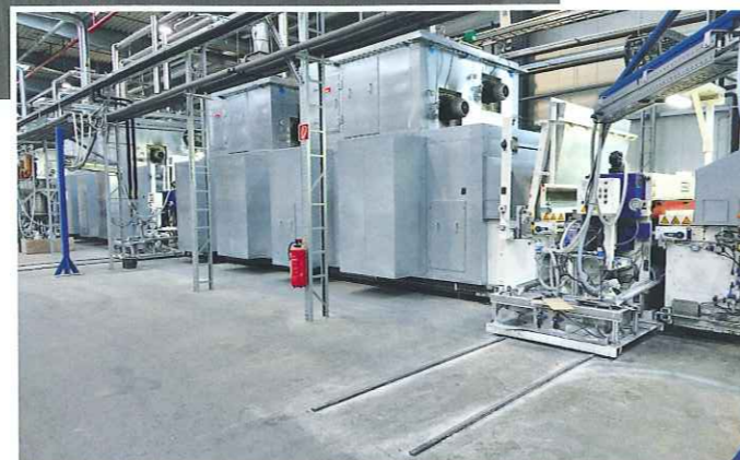
Hymmen 45 m-Produktionslinie mit Digitaldruck/Flüssigbeschichtung/Doppelbandpresse
