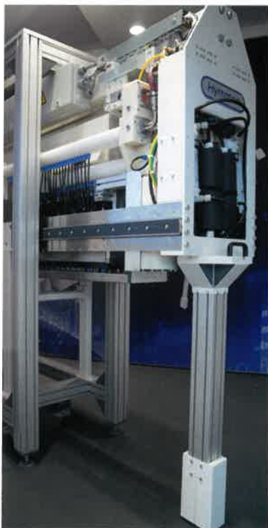
Das Kernstück der Anlage, den Druckbalken, zeigte Hymmen auf der Ligna.
