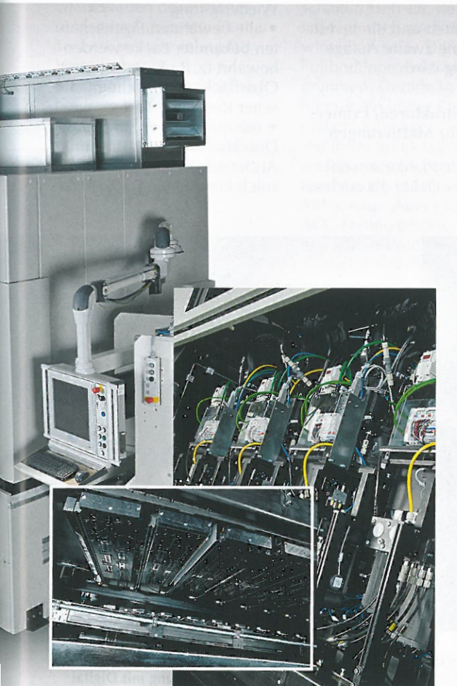
Abb. 4: Die Digitaldruckanlage „JPT-CS“ für den Digitaldruck auf Einzeldielen
