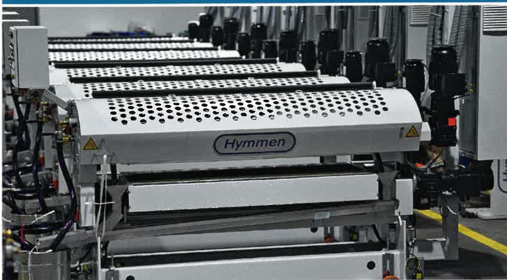
Abb. 2a: Flüssigbeschichtungsmaschinen („ULX“)
