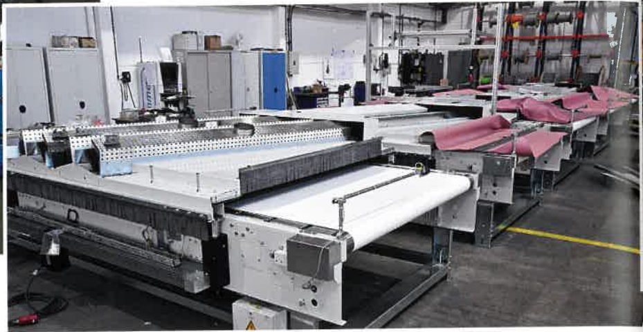
Abb. 4: Transporteinheiten mit UV-Trocknern von Hymmen vor der Auslieferung
