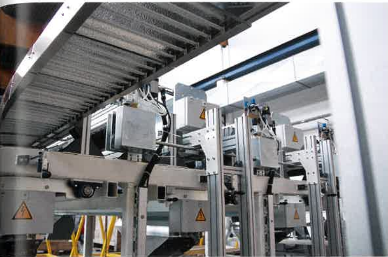
Abb. 5: Scheibentransport mit Infrarot-Trockner
