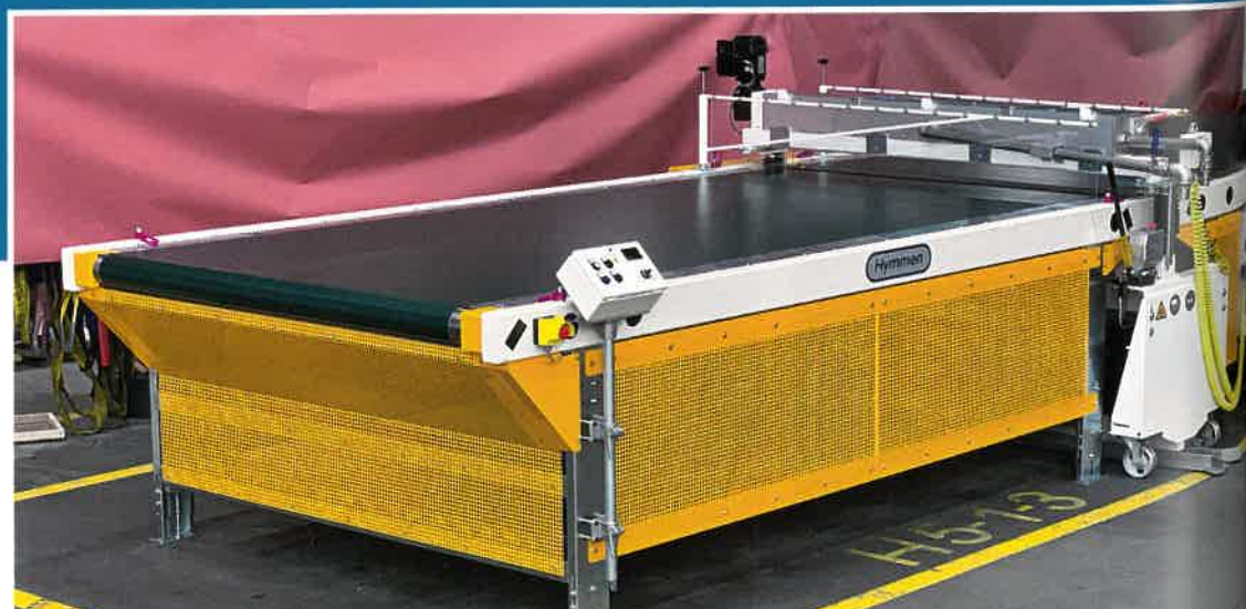
Abb. 2b: Flüssigbeschichtungsmaschine („MTC“)
