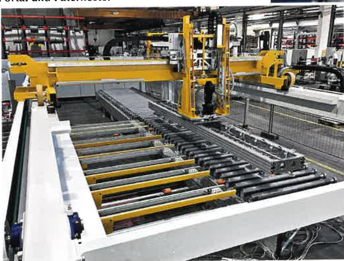
Abb. 6: Rollentransportbahn, Portal und Paternoster
