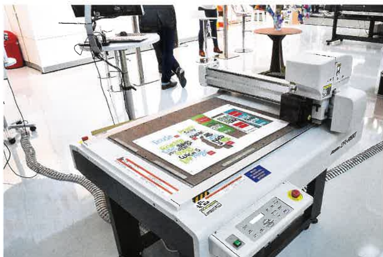
Der Schneideplotter „CFL-605RT“ bietet eine Vielzahl von Möglichkeiten zum Schneiden und Rillen
