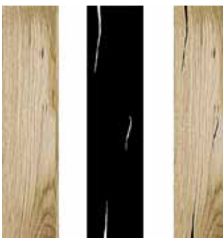
Diele mit „künstlichem“ Riss (vorher, Digitaldruckmaske, nachher)
