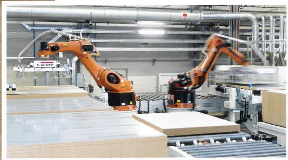
>Die Beschickung der Calander Coating Inert-Anlage von Hymmen bei Egger im Werk im westfälischen Brilon erfolgt mit Robotern.
