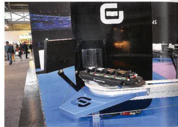
Die „Digi-7-Single-Pass“-Digitaldruckanlage von Bergstein verfügt über ein umlaufendes Transportband mit Werkstück-Aufnahmen, welche die zu bedruckenden Teile durch die Anlage befördern
