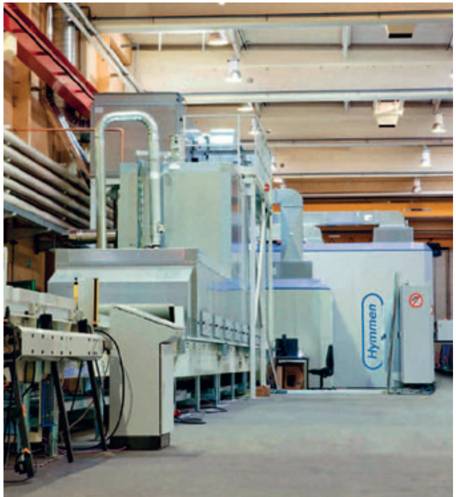
▲ Blick auf die Auslaufseite der über 70 m langen Digitaldruckanlage bei Hörmann
