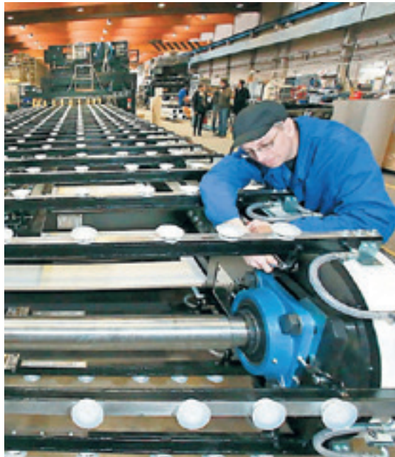
Innovativer Präzisionstransport: Vitali Nering justiert die Spur, auf der die Platten liegen.
