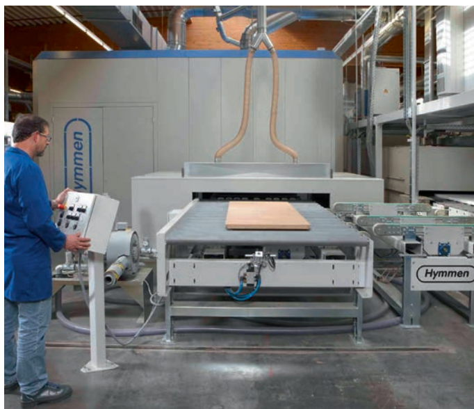
Eine Hymmen Digitaldruckanlage für den Druck auf Türen Fotos: Hymmen
