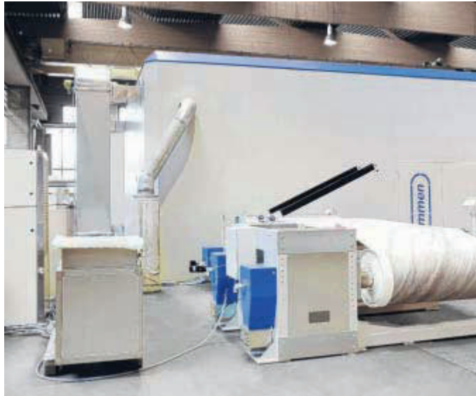
Moderne Druckanlage für Oberflächen: Die industrielle Digitaldruckanlage JPT-W 1400.
