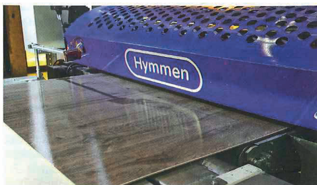
>Oben: Eine fertig digital bedruckte Platte mit Decklack vor der Trocknung. Großes Bild: Ein Blick in eine industrielle Digitaldruckanlage von Hymmen.
