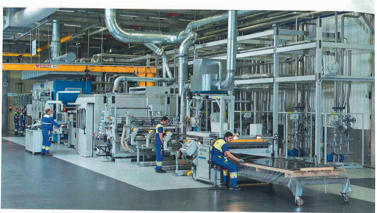
Abb. 3: Das Hochglanzlaminat aus der Hymmen HPL-Doppelbandpresse bei Egger, rechts im Bild sichtbar (Foto: Egger)
