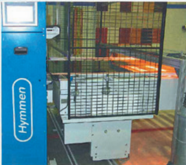
... wo der UV-Lack unter inerten Bedingungen durch eine Folie hindurch getrocknet wird
