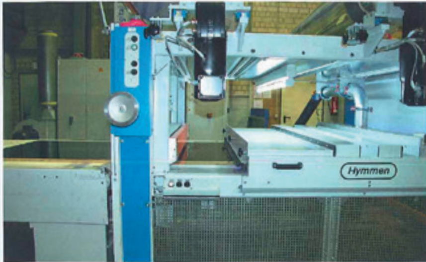
... wo der UV-Lack unter inerten Bedingungen durch eine Folie hindurch getrocknet wird
