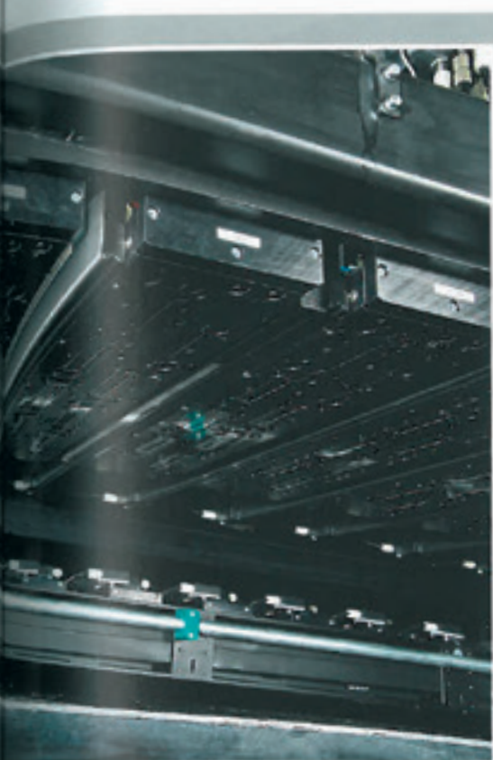
Die integrierte UV-Trocknung der Oberfläche und Druckköpfe von unten
