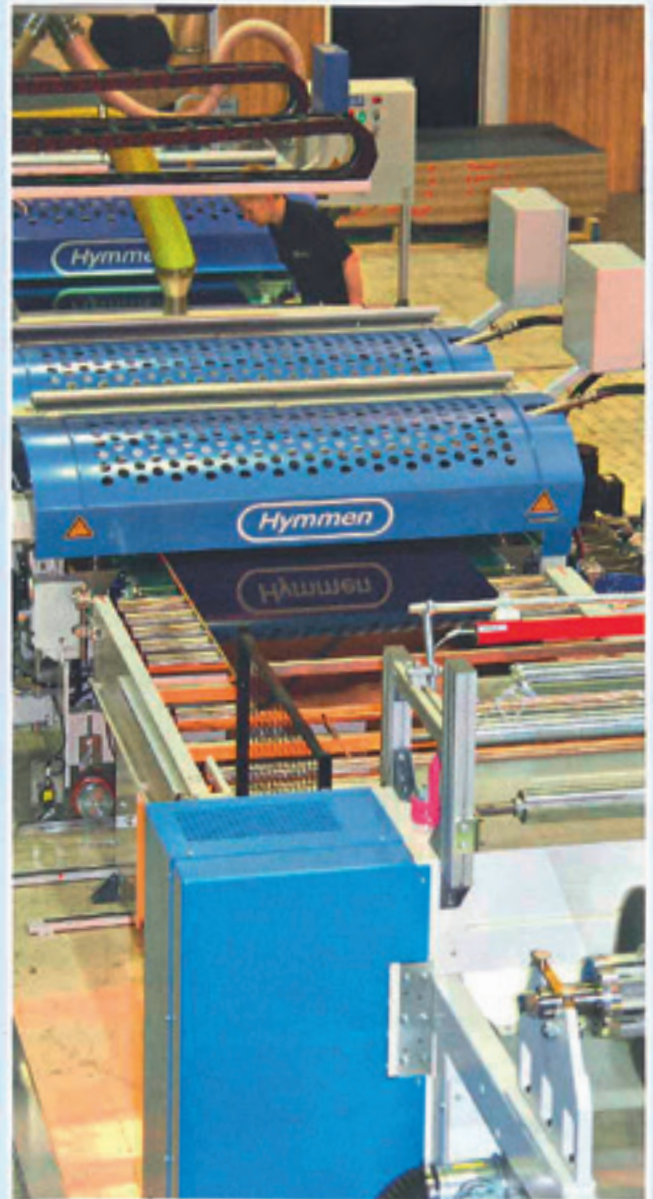
Die lackierten Oberflächen kommen im noch nassen Zustand in den Kalender ...
