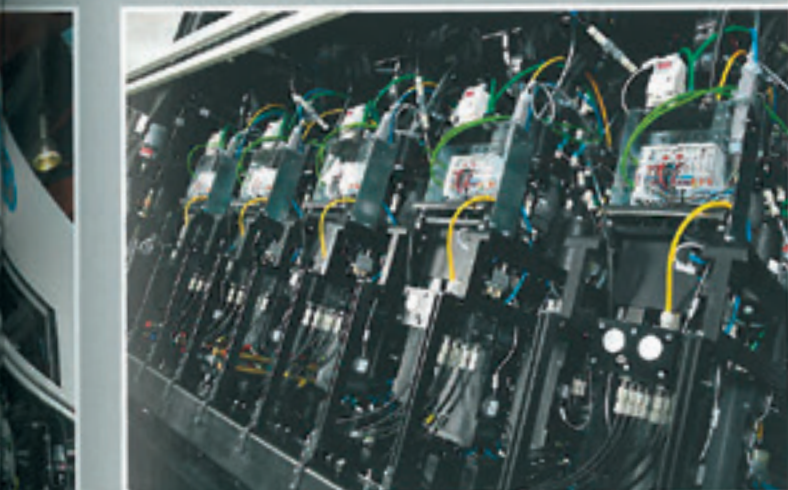
In den Tinten-einheiten steckt der Kern des Digitaldruck-Know-hows von Hymmen
