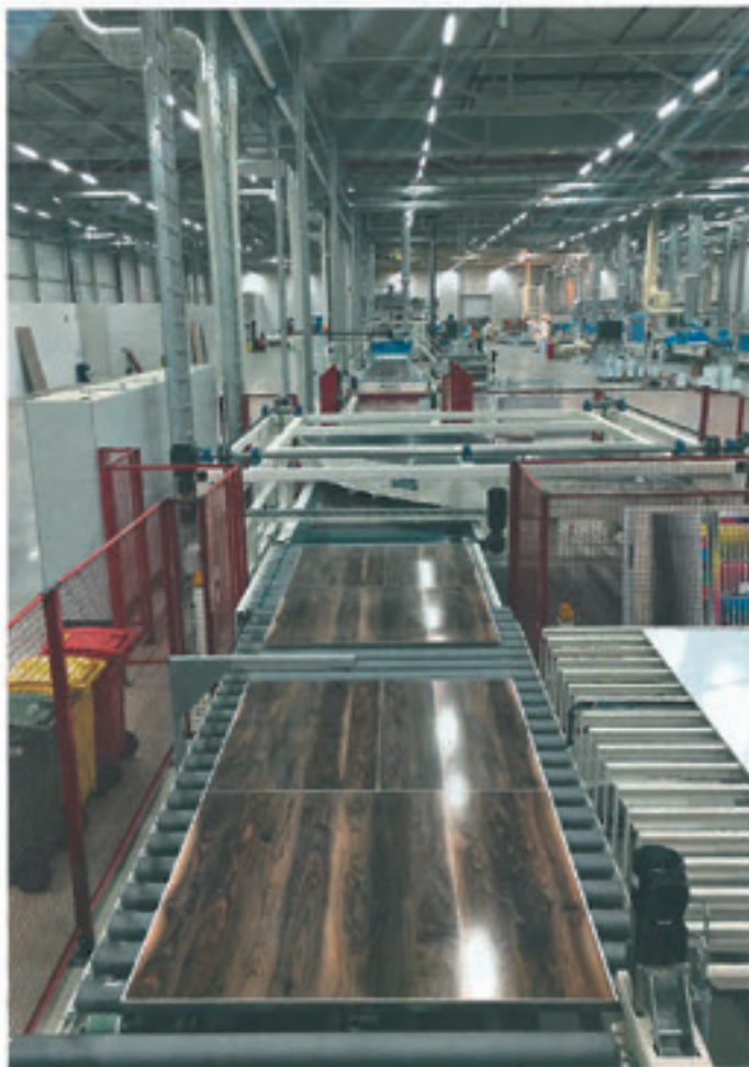
Plattenauslauf nach dem Decklackauftrag, hinten die Digitaldruckanlage (rechts)
