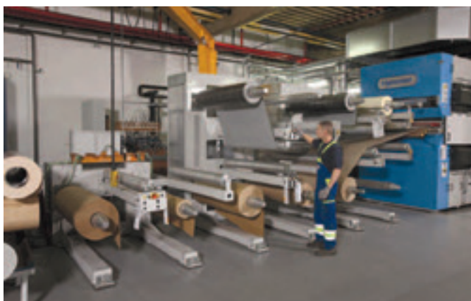
◀ Auslaufbereich der Hymmen Doppelbandanlage (Fotos: Egger)
